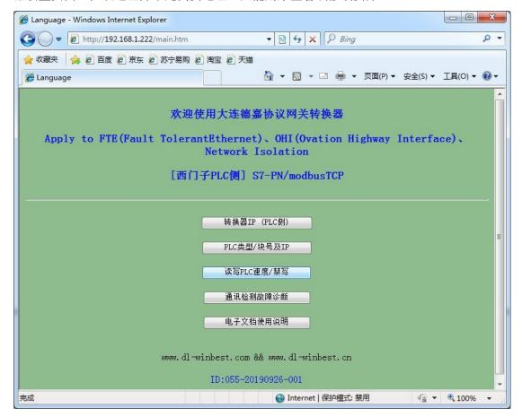
2、转换器的 IP 地址(PLC 侧)要与西门子 PLC 的 IP 地址处于同一段址中,如: 192.168.1.10,这里使用的是 CPU315-2 PN/DP,其 IP 地址为 192.168.1.30。
