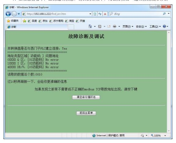
5、连接 Modbus TCP 侧设置,用电脑通过网线连接 LAN3 的网口(或经过交换机与 LAN3 连接),如果不知道转换器的实际 IP 地址(或忘记了),你可以使用后门 IP 地址(192.168.1.222)来进入转换器设置页面,但该地址并不是真实地址,只能用来查看或修改实际 IP。
