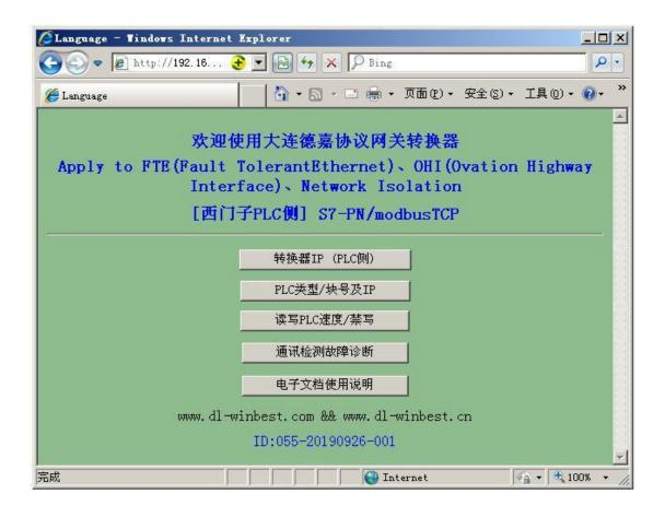
2、转换器的 IP 地址 (PLC 侧) 要与西门子 PLC 的 IP 地址处于同一段址中,即 IP 地址的前 3 段完全一样,第 4 段不一样 (切记! 千万不能一样),用鼠标点击"转换器 IP (PLC 侧)",就进入了下面的 IP 设置页面,只需修改 IP,而 MAC 则无需改变。
