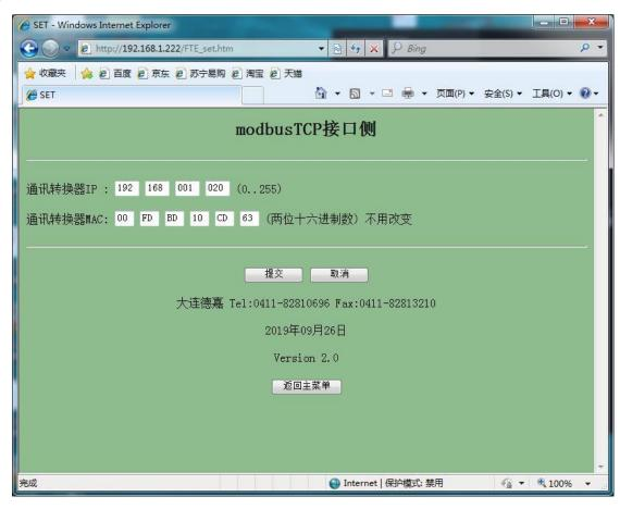
7、使用 Modbus Poll 调试软件测试如下,连接时, IP 填: 192.168.1.20,端口号: 502,选择 03 功能码(4xxxx), Modbus 寄存器地址从 0 开始读 10 个,可见通讯成功。
