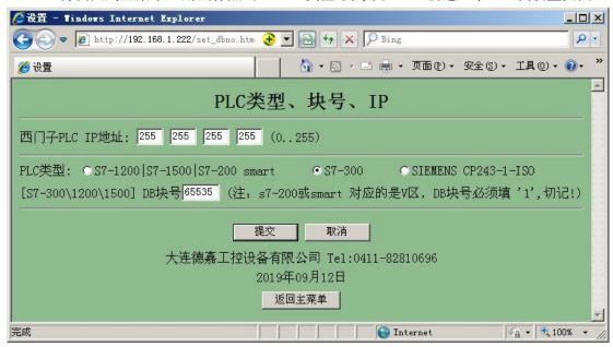
在该设置页面中选择所连的 PLC 的 IP 地址以及 PLC 类型, 如果是 S7-300\1200\1500,还要填写用于通讯的 DB 块号, 而 S7-200 或 smart 使用 V 区, DB 块号填'1'
