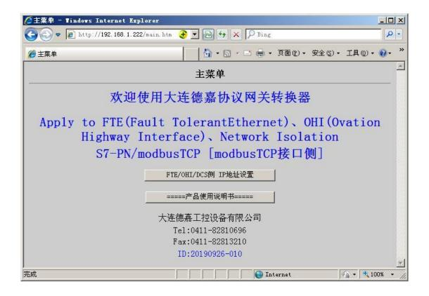
转换器的 IP 地址(ModbusTCP 侧)要与电脑或 DCS、MIS、霍尼韦尔的 FTE、艾默生的 OHI 等具有 Modbus TCP 协议的设备 IP 地址处于同一段址中,既 IP 地址的前 3 段完全一样,第 4 段不一样(切记! 千万不能一样),用鼠标点击"FTE/OHI/DCS 侧 IP 地址设置",就进入了下面的 IP 设置页面:
