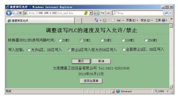
该页面用于控制读写 PLC 速度(准确说是频率)及写保护,如果通讯数据量小,请选 [100MS];如果不对 PLC 进行写操作,请选 【全面禁止 Q 区、DB 区写入】
